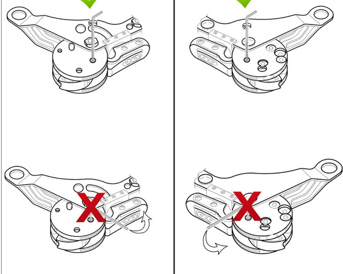
Für den Test ist bitte der beim SpiderJack 3 mitgelieferte, dünnere Sechskantschlüssel (SW 2,5 mm) zu verwenden.
