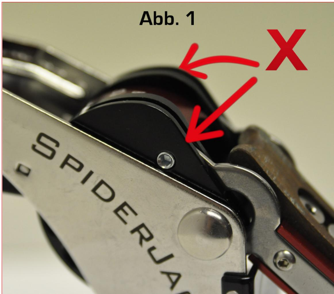
**Jeder Anwender eines SpiderJack 3, Seriennummer: 25.16..., wird daher aufgefordert, diese Überprüfung, der dargestellten Anleitung (Abb. 2) folgend, umgehend durchzuführen!**
